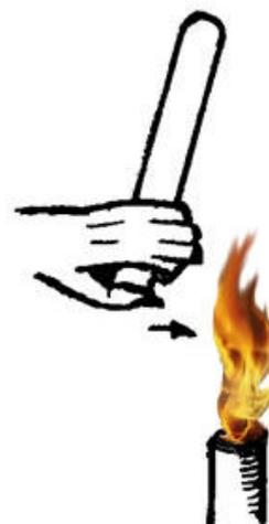
Je nachdem wie heftig die Reaktion verläuft (ruhiges Abbrennen, pfeifendes Geräusch, Knall), kann man auf ein optimales Mischungsverhältnis schließen. Bei einem Volumen-Verhältnis von  $H_2$  / Luft wie  $3/7$  soll es optimal sein.
